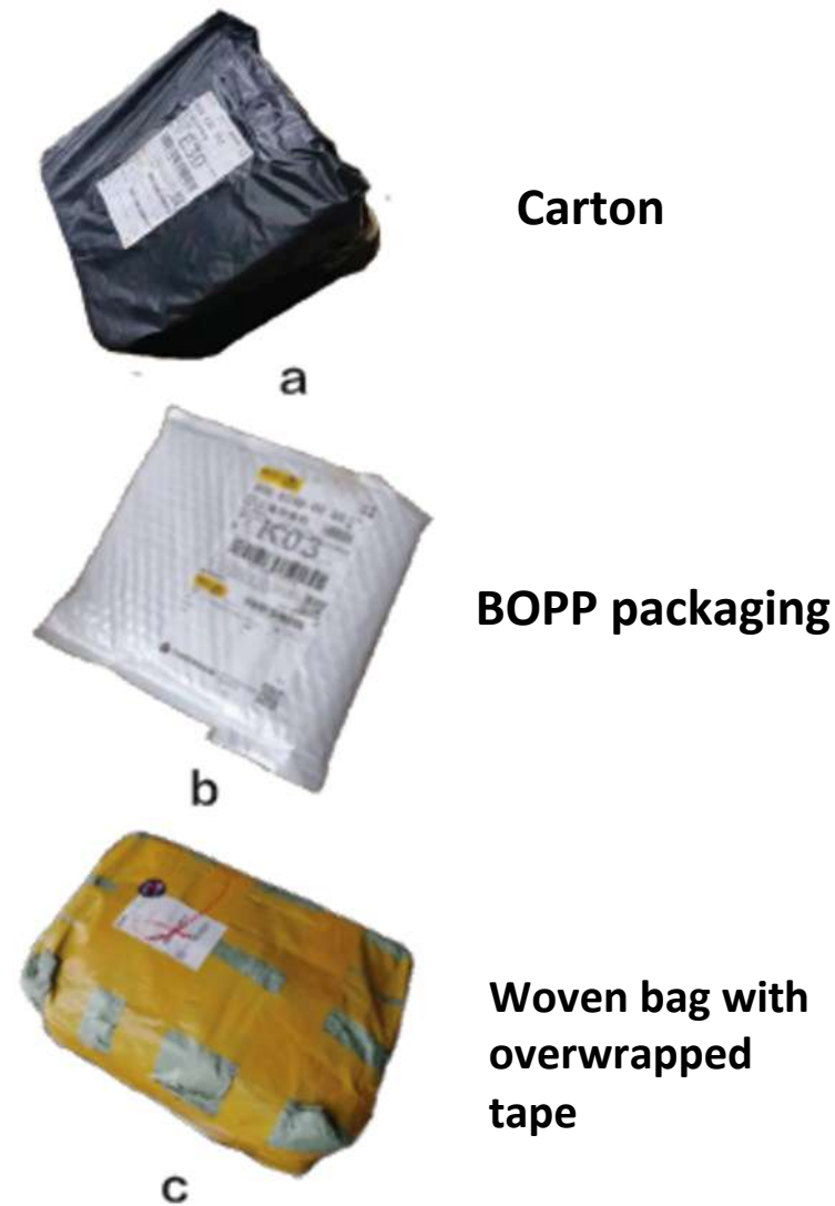
图 1-3 典型快递包装材料 (a. 套袋纸箱; b. 珠光袋; c. 胶带过度缠绕的编织袋)
